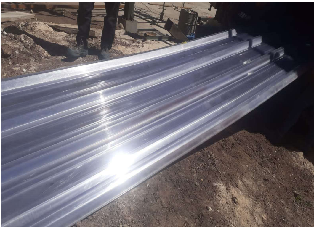
IMAGEN 08: COBERTURA POLICARBONATO TRASLUCIDO DE 1 MM
